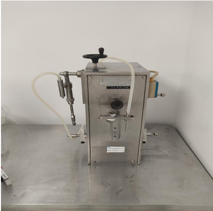
Μηχανή Πλήρωσης Plastic Strips_Capsulit
